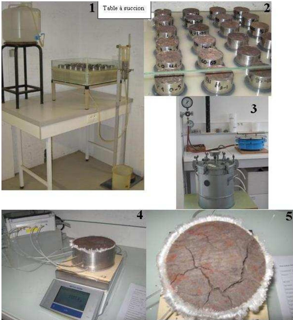
Figure II.3 - Dispositifs de mesure des propriétés hydrodynamiques : (1) dispositif de table à suction; (2) échantillons non remaniés en phase d'équilibre sur table à suction; (3) marmite de Richard ; (4) échantillons de sol sur banc expérimental Wind ; (5) apparition de fissures et d'une couronne de filaments de sels (essentiellement formés d'hexahydrate) en fin de phase de dessiccation de l'échantillon sur le dispositif Wind.
