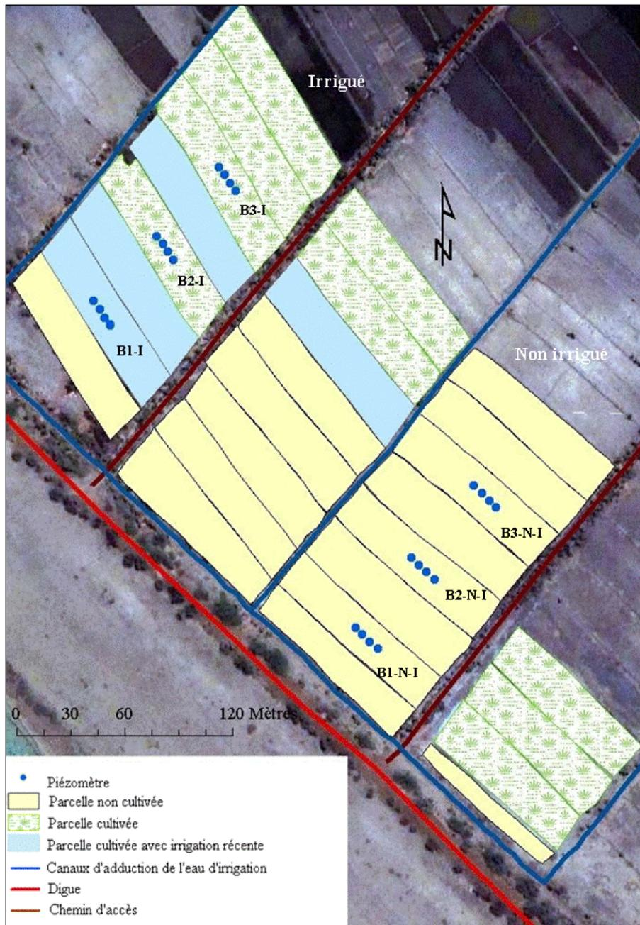
Figure IV.1 - Vue aérienne du dispositif de suivi
