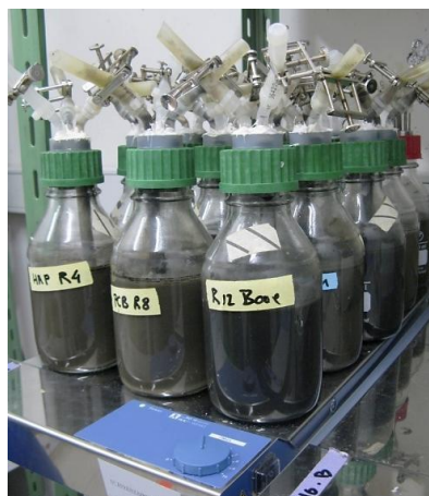
Figure II-3: Dispositif expérimental des réacteurs anaérobies
