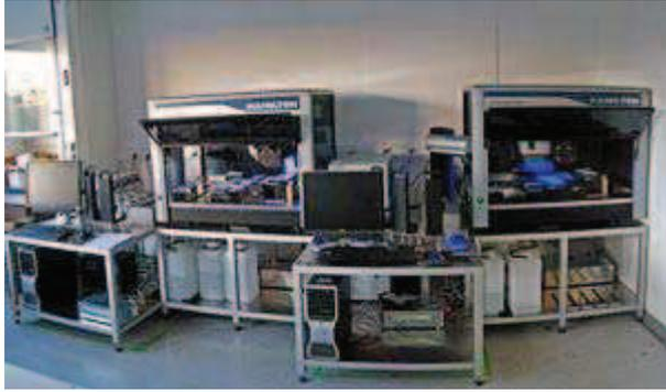
**Figure 4:** Robots pipeteurs utilisés lors de l'étude phénotypique. Le robot a servi la distribution et au pipetage à haut débit des milieux, cultures, et mélanges réactionnels des tests enzymatiques
