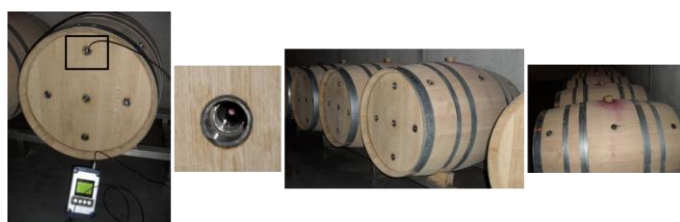
Figure 59 : Barriques expérimentales pour la mesure de l'oxygène dans le vin
