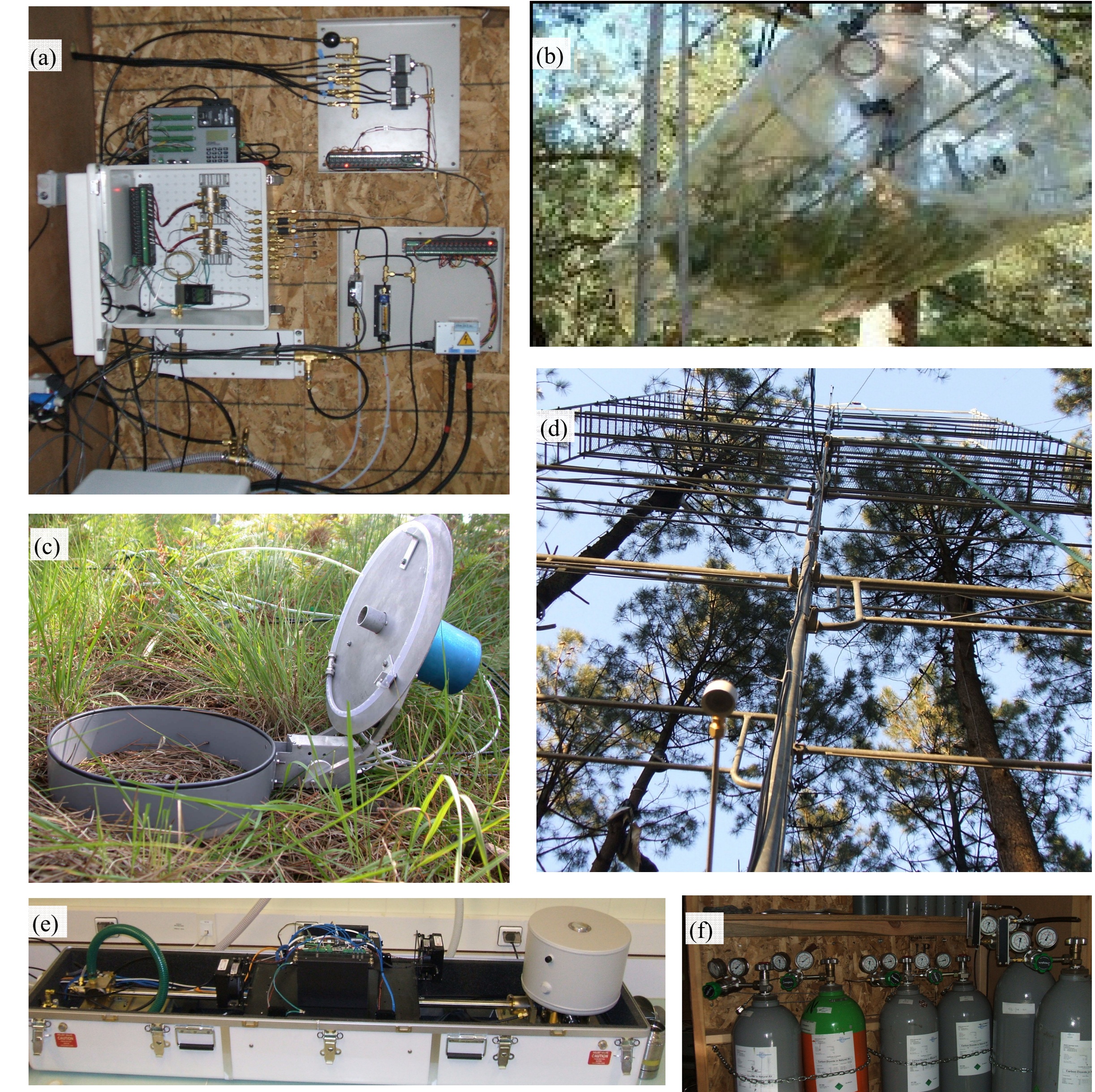
Fig 2: Photos du dispositif (a) Système d'échantillonnage (b) Branch Bag (c) Chambre de respiration du sol (d) échafaudage pour profil (e) spectromètre à diode laser modulable (Campbell Sci, TGA100A) (f) gaz étalon
