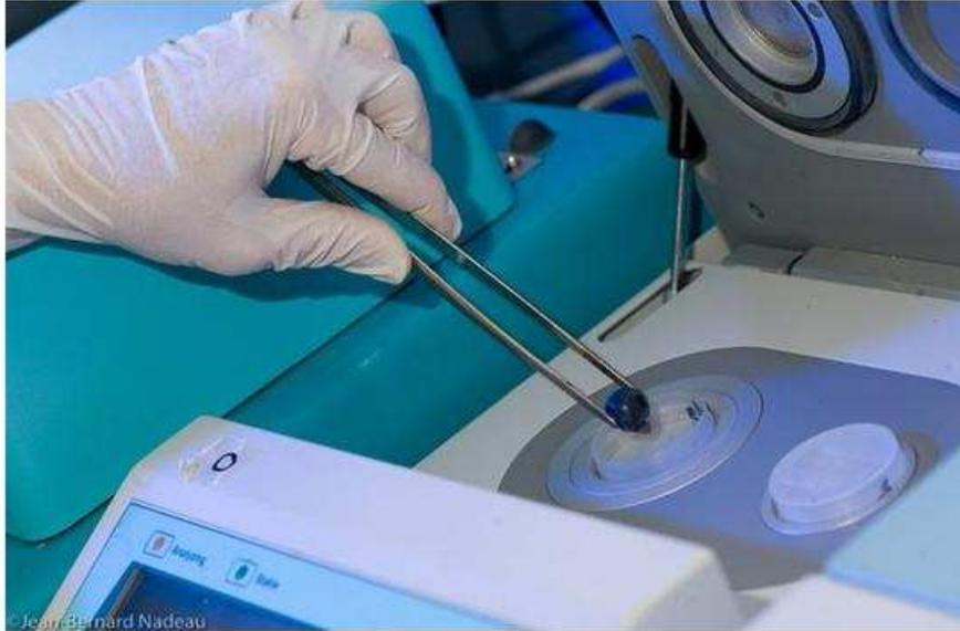
**Figure 20** : Photo AW-mètre (Labmaster, Novasima).
