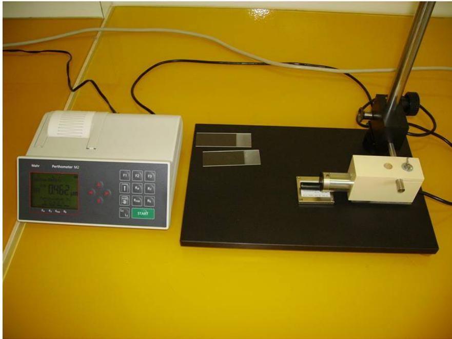
Figure II-10 : Photographie du rugosimètre Mahr M2 (Mahr GmbH, Göttingen, Germany).
