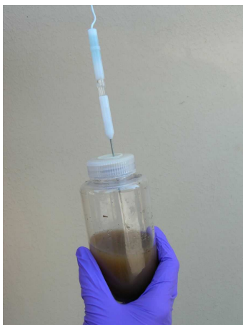
Figure 3 – Mesure du potentiel d'oxydo-réduction du système au travers du septum.
