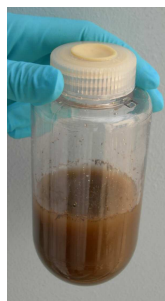
Figure 2 – Système « batch » : flacon à centrifugation de 250 ml équipé d'un septum.
