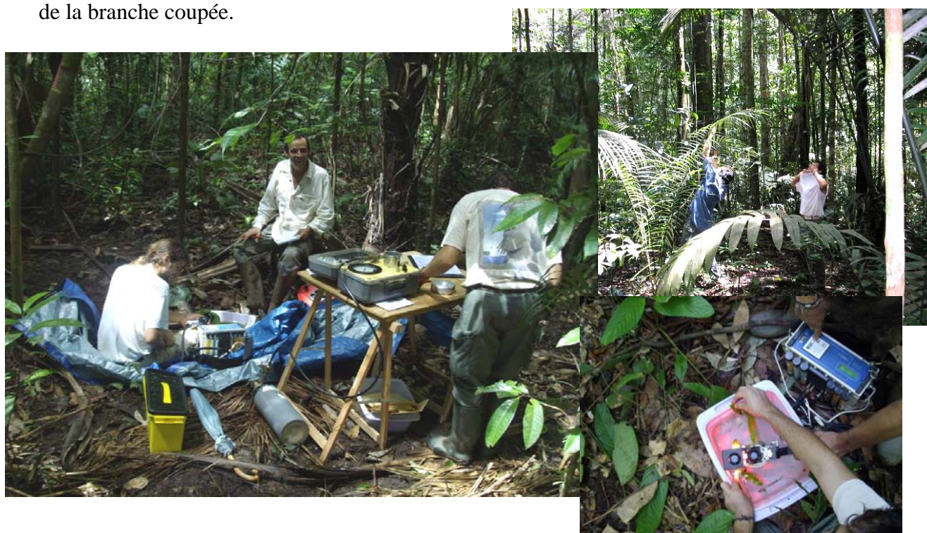
Figure 15 : Prélèvement et mesure des échanges gazeux foliaires et potentiels hydriques en sous-bois sur rameaux coupés.
