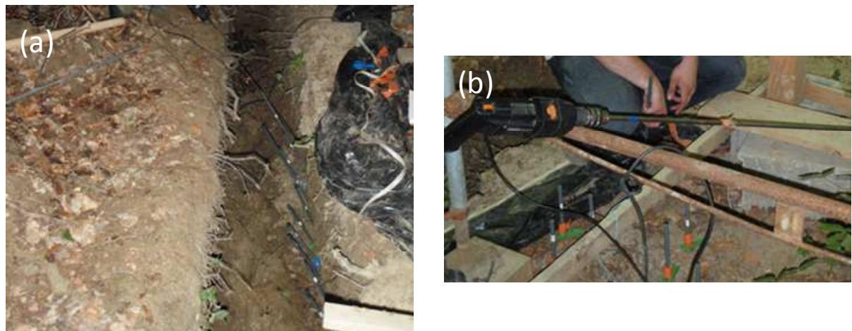
Figure 24: dispositif de l'expérimentation d'« ascenseur hydraulique ». 21 tubes ont été insérés obliquement depuis le front de fosse à une profondeur de 70- 90 cm (a). 24 tubes ont été placés verticalement, à proximité des arbres d'intérêt (b) à une profondeur de 90 cm. Dans chaque cas, les tubes ont ensuite été relevés de 25 cm, offrant ainsi un volume libre de 25 mL, situé au plus haut à 65 cm de profondeur. Ce volume libre empêche les risques de remontées capillaires le long des tubes.
