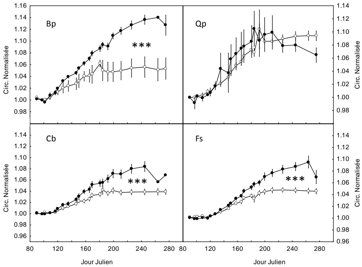
**Figure 13 :** Evolution saisonnière des circonférences normalisées (rapport des circonférences mesurées sur les circonférences initiales) dans la cuve de dessèchement (en blanc) et dans la zone témoin (en noir) entre mi-mars et début octobre 2007. Chaque point représente la moyenne des arbres étudiés dans chaque traitement pour une date de mesure. Les barres représentent les erreurs-standard (\*\* différences significatives à 0.001 entre les 2 traitements au jour 240)
