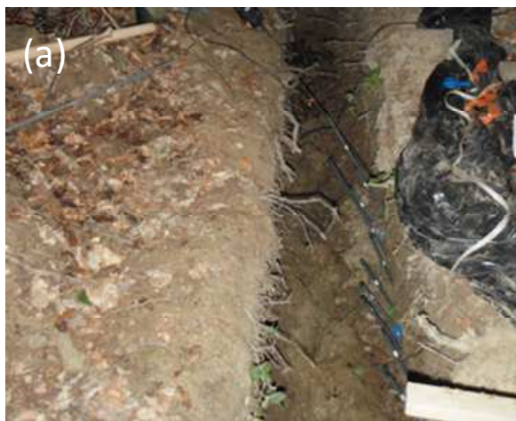
Figure 24 : dispositif de l'expérimentation d' « ascenseur hydraulique ». 21 tubes ont été insérés obliquement depuis le front de fosse à une profondeur de 70- 90 cm (a). 24 tubes ont été placés verticalement, à proximité des arbres d'intérêt (b) à une profondeur de 90 cm. Dans chaque cas, les tubes ont ensuite été relevés de 25 cm, offrant ainsi un volume libre de 25 mL, situé au plus haut à 65 cm de profondeur. Ce volume libre empêche les risques de remontées capillaires le long des tubes.
