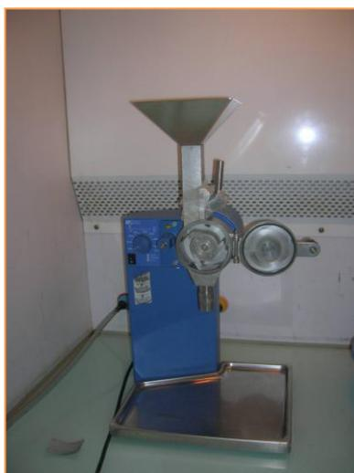
**Figure 20 : Photographie du broyeur.**
