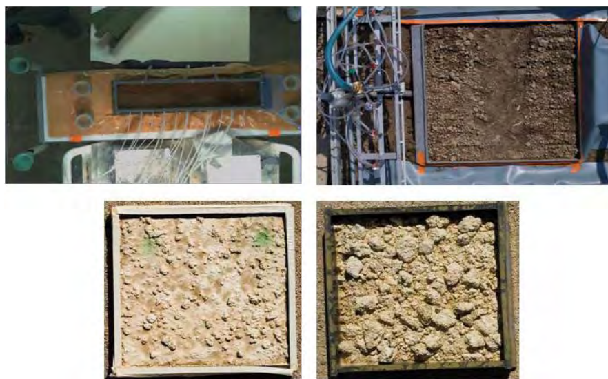
Figure 2-42: Photos des différentes surfaces étudiées. a) maquette-a (en haut à gauche) ; b) les surfaces reconstruites maquette-lisse (en bas à gauche) et maquette-rugueuse (en bas à droite) ; c) placette au champ (en haut à droite)
