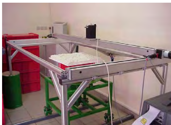
Figure 2-3: rugosimètre à faisceau laser pour une utilisation au laboratoire. La diode laser et le dispositif optique sont installés sur un chariot pouvant se déplacer dans les deux directions horizontales. La durée nécessaire à l'acquisition d'un MNT sur une surface carrée de 50 cm de côté est de plusieurs heures. L'automatisation du dispositif permet une acquisition en temps masqué (la nuit par exemple) (Kamphorst and Duval, 2001).
