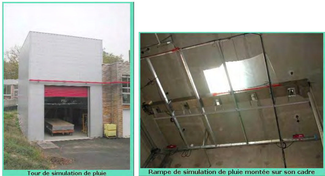
Figure 3-19 : photographies de la halle expérimentale (à gauche, vue de l'extérieur) et du simulateur de pluie (à droite).
