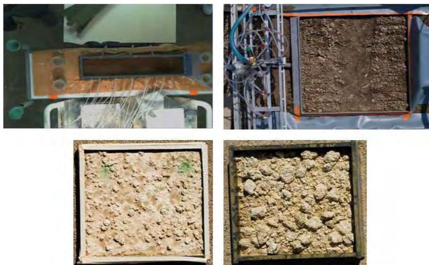
Figure 2-42: Photos des différentes surfaces étudiées. a) *maquette-a* (en haut à gauche) ; b) les surfaces reconstruites *maquette-lisse* (en bas à gauche) et *maquette-rugueuse* (en bas à droite) ; c) placette *au champ* (en haut à droite)
