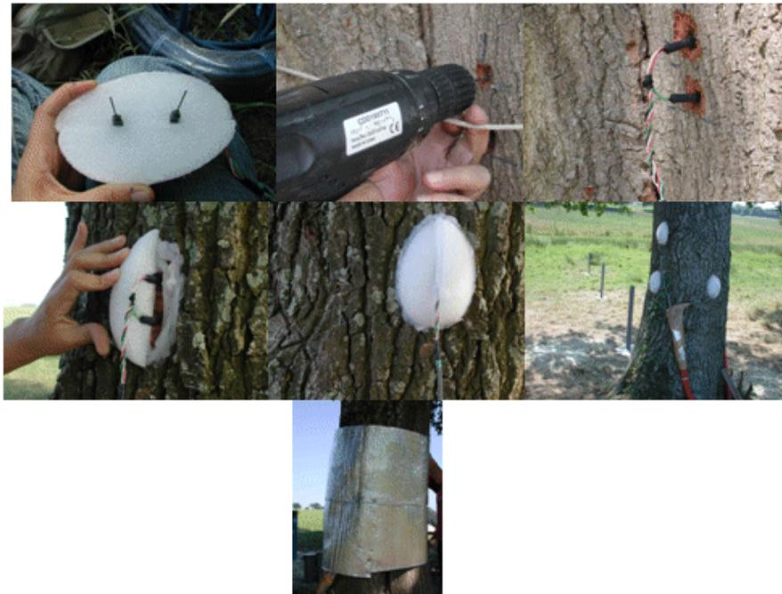
Figure 2.7 : Mise en place des capteurs de flux de sève
