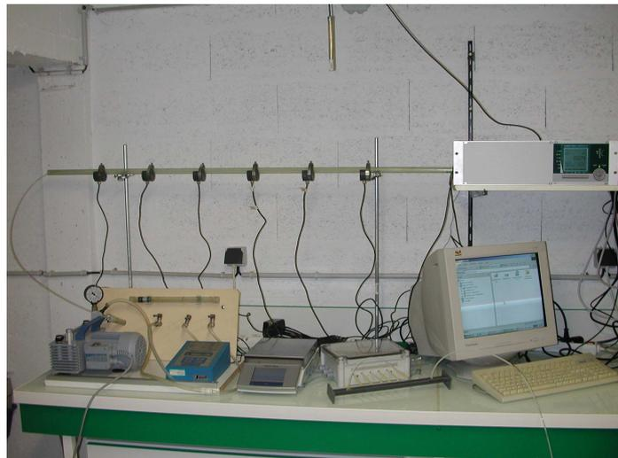
Figure 2.11 : Banc d'étalonnage des capteurs de pression (SKT 850).
