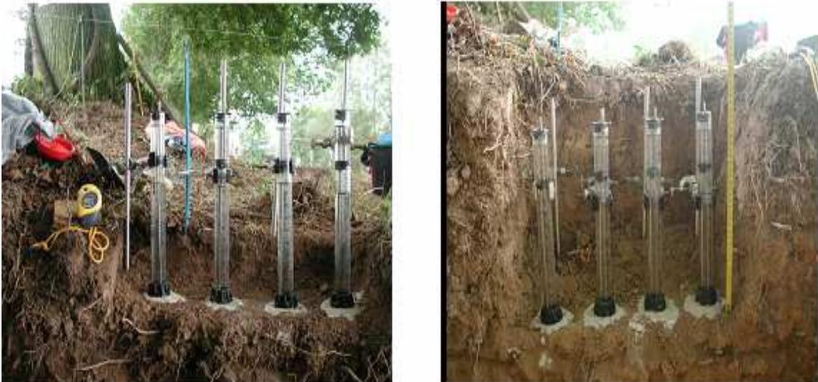
Figure 2.9 : Mesure de la conductivité hydraulique par mini infiltromètre (Decagon's handheld Mini-disk).
