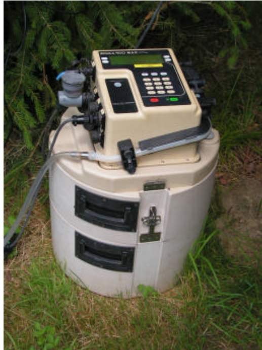
Fig. 6 - Un préleveur automatique programmable sur alarme de niveau d'eau.
