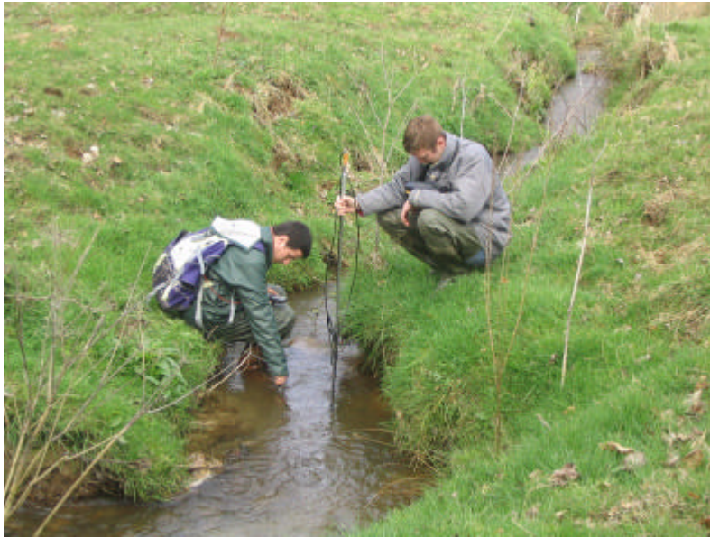
Fig. 21 - Mesures itinérantes de turbidité et de débit.
