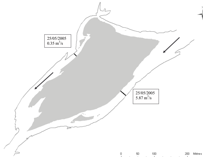
FIG. 9.9 - Positions et valeurs des jaugeages de la station D0 au 25 mai 2005 (extrait de [Le Coarer et al., 2005])
