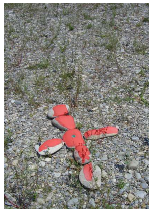
FIG. 9.10 - Une mire sur le terrain. Chaque galet fait une quinzaine de centimètres de long.
