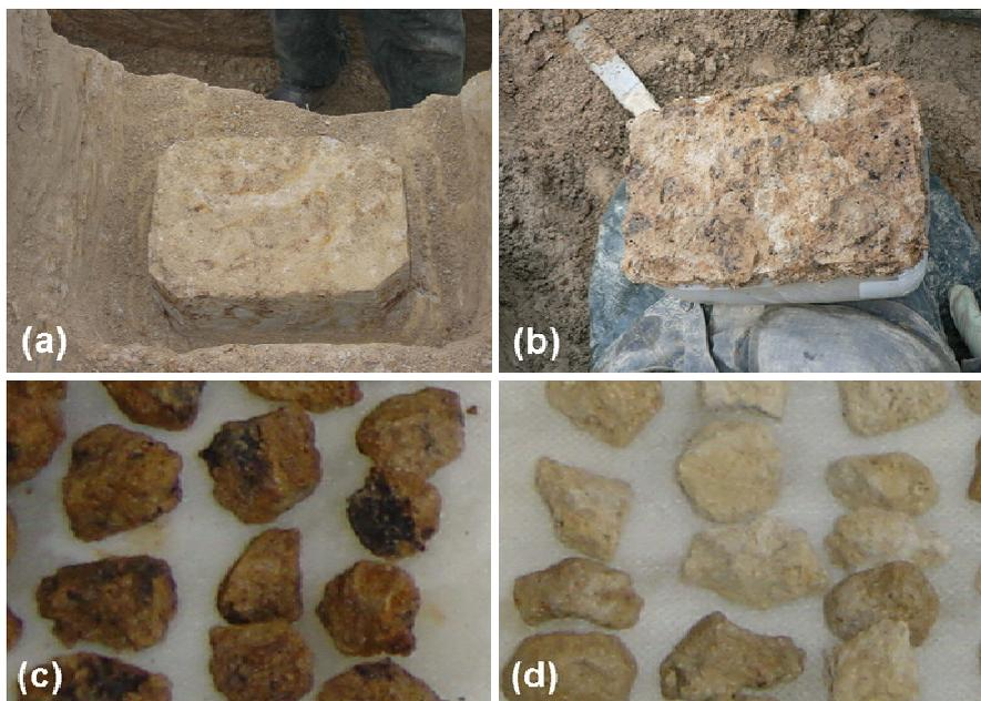
*Figure II-4 : Illustrations de l'échantillonnage avec le prélèvement de monolithes de sols non perturbés (a et b) et les VPE ocre (c) et clairs (d) extraits manuellement de ces monolithes*
