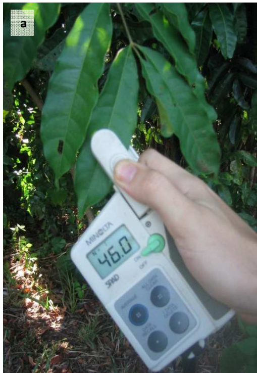
Figure 1. a. SPAD-502 (Konica Minolta, Osaka, Japon) : analyseur portatif qui permet d'estimer les concentrations en chlorophylles foliaires sans prélèvements, par l'intermédiaire de mesures de transmittance des feuilles. b. Spectres d'absorption des chlorophylles a (vert) et b (rouge).
