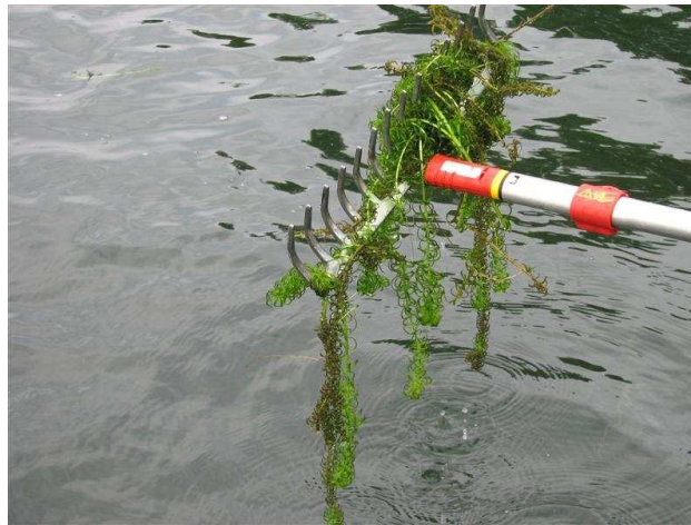
Figure 17. Râteau utilisé pour prélever les macrophytes (sur cet exemple, on prendrait le coefficient de 3).
