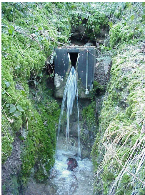
La source du Bélier – dispositif limnimétrique (photo. E . Venet)
