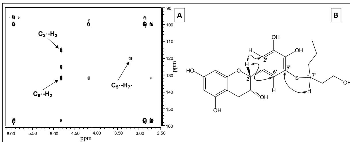
**Figure 47.** (A) Section de la carte HMBC de l'adduit 5'-(7'-sulfanylhexanol)-(-)-épicatéchine (**E2**), (B) structure de l'adduit **E2** (les flèches représentent les principales corrélations proton-carbone à longue distance observées sur la carte HMBC)
