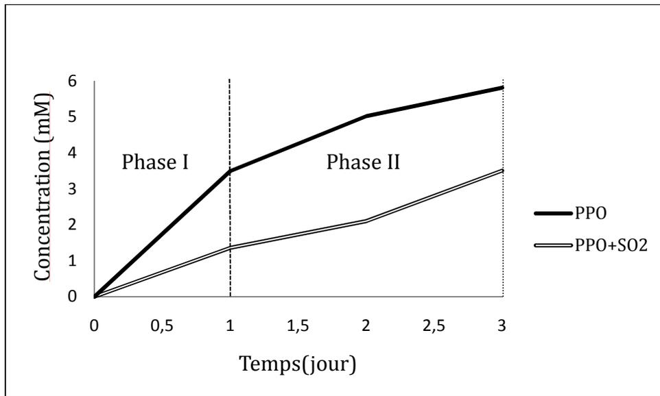
**Figure 51.** Cinétique de formation de l'adduit Caf2, entre le 3SH et l'acide caftarique, en conditions d'oxydation enzymatique (PPO), en présence (PPO) ou non de dioxyde de soufre (PPO + SO<sub>2</sub>) (50 mg/L)
