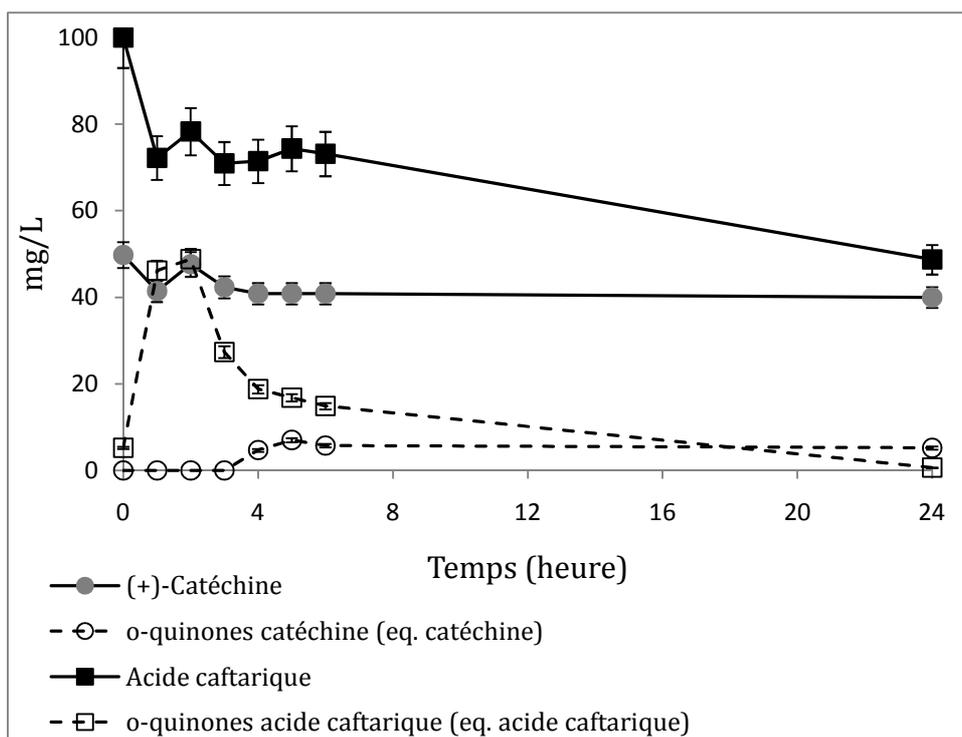
**Figure 80.** Cinétique d'oxydation de la (+)-catéchine et de l'acide caftarique en présence de polyphénoloxydase (PPO) au cours des 24 premières heures après ensemencement avec des levures *Saccharomyces cerevisiae* (début de fermentation alcoolique 24h après ensemencement)
