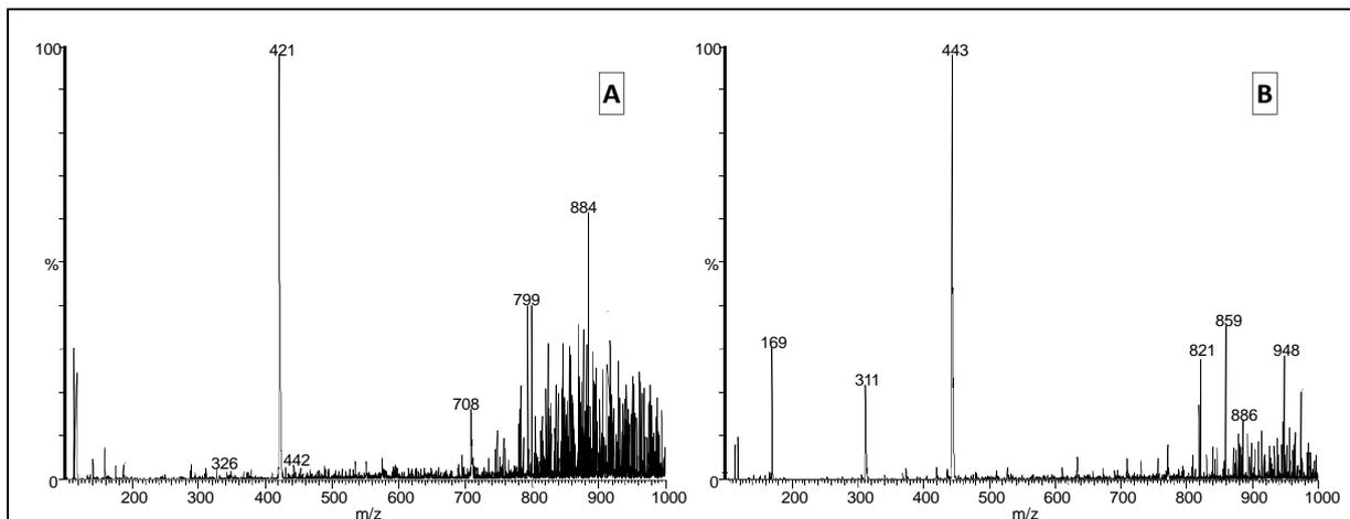
**Figure 58.** Spectres de masse en mode négatif et en Full Scan sur une gamme de masse 100-1000, des adduits **(A) C2** : 5'-(7''-sulfanylhexanol)-(+)-catéchine et **(B) Caf2** : acide 2'-(3''-sulfanylhexanol)-caftarique identifiés dans le moût blanc supplémenté en **3SH** à 24 heures d'incubation
