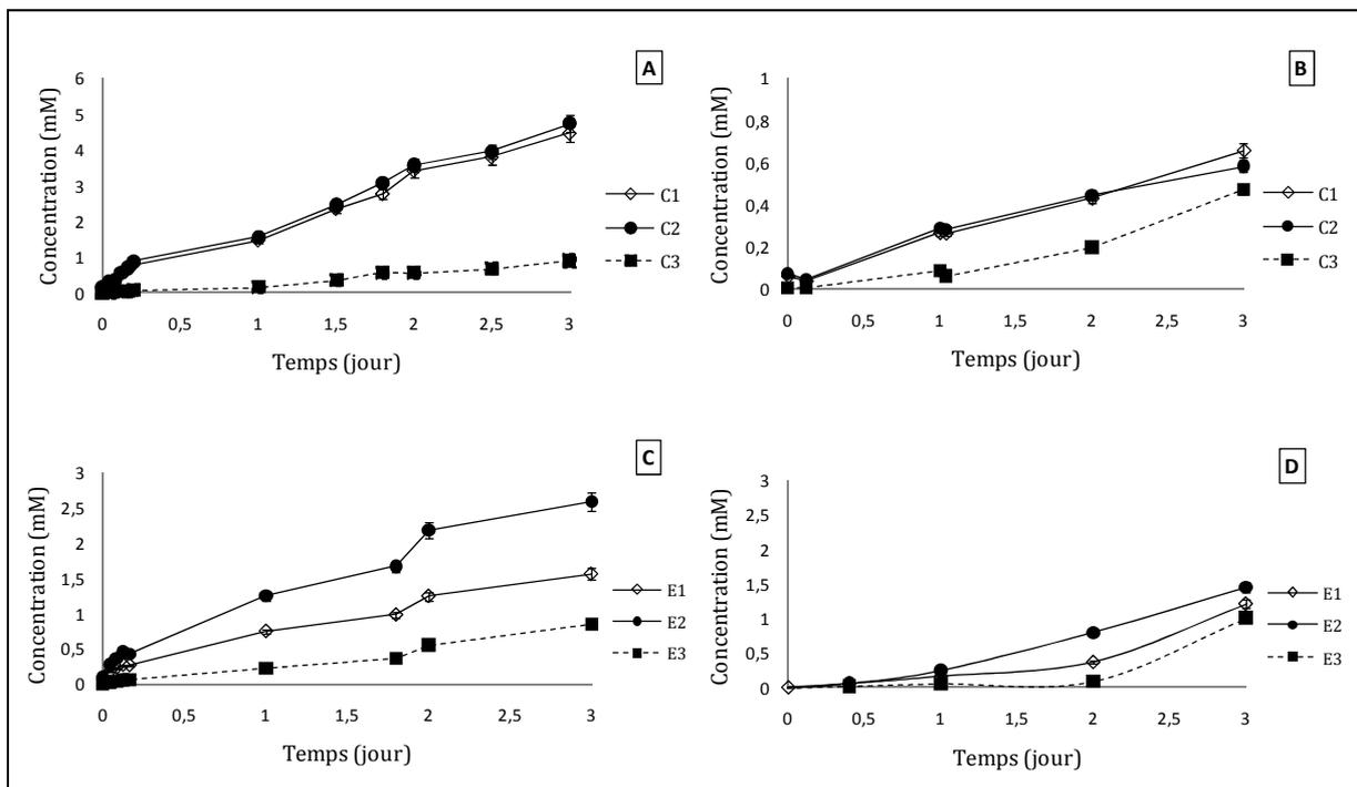
**Figure 50.** Cinétique de formation des adduits entre le 3SH et les monomères de flavan-3-ols [(+)-catéchine et (-)-épicatéchine] en conditions d'oxydation enzymatique. Incidence de la présence du dioxyde de soufre. Cinétique de formation des adduits **(A) C1, C2 et C3** en présence de la PPO, **(B) C1, C2 et C3** en présence de la PPO et du dioxyde de soufre, **(C) E1, E2 et E3** en présence de la PPO et **(D) E1, E2 et E3** en présence de la PPO et du dioxyde de soufre
