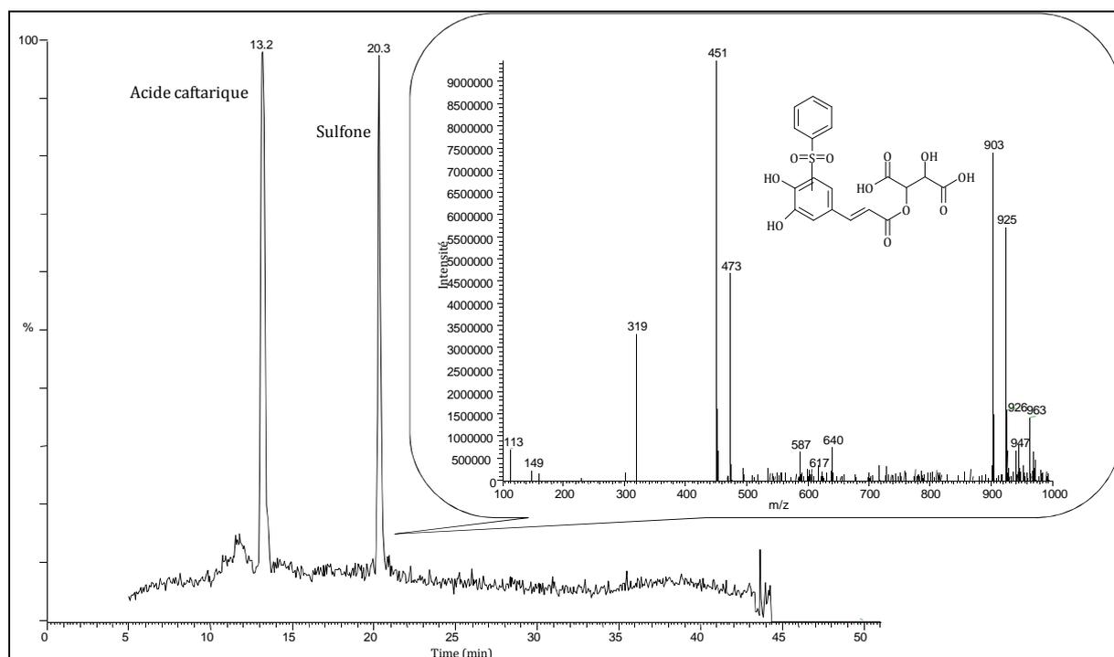
**Figure 26.** Chromatogramme (TIC) et spectre de masse en mode Full Scan du milieu réactionnel de l'hémisynthèse des sulfones de l'acide caftarique (20,3 min)
