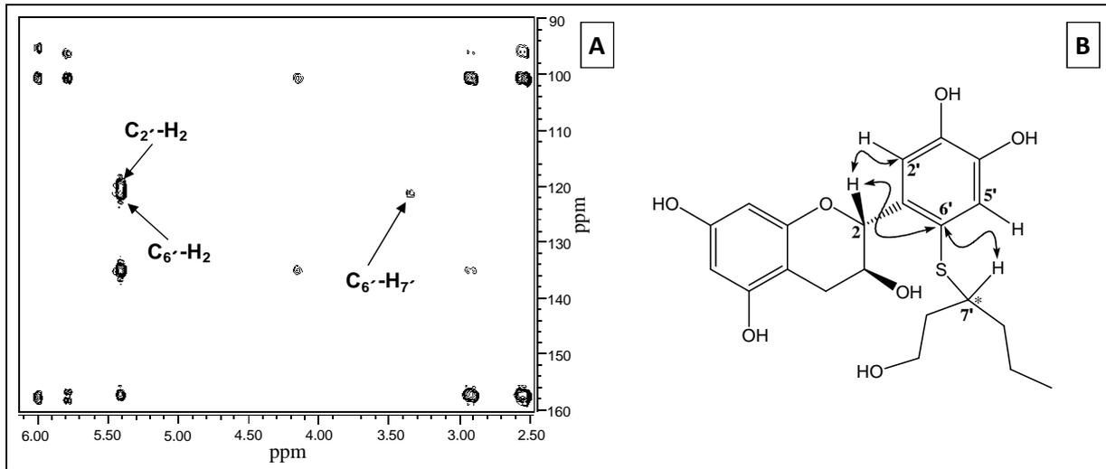
**Figure 41.** (A) Section de la carte HMBC de l'adduit 6'-(7'-sulfanylhexanol)-(+)-catéchine (C1b), (B) structure de l'adduit C1b (les flèches représentent les principales corrélations proton-carbone à longue distance observées sur la carte HMBC)
