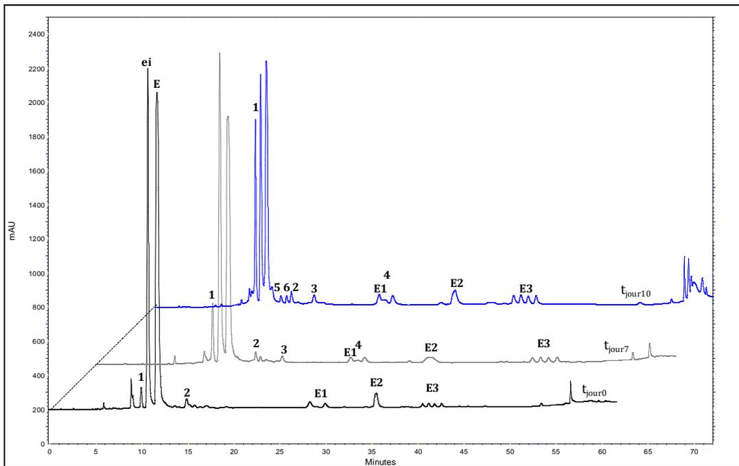
**Figure 55.** Suivi par CLHP-UV à 280 nm du milieu réactionnel contenant de la (-)-épicatéchine et du 3SH au cours de 10 jours de réaction. Evolution de la formation des adduits entre la (-)-épicatéchine et le 3SH (E1, E2 et E3) mais aussi des produits de dégradation de la (-)-épicatéchine : pics chromatographiques de 1 à 6
