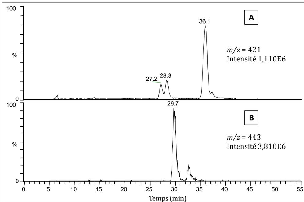
**Figure 57.** Chromatogrammes en CLHP-ESI-SM d'un extrait organique brut de moût blanc supplémenté en **3SH**. Le chromatogramme **(A)** correspond au chromatogramme extrait à  $m/z = 421$  (adduit **C2**) et le **(B)** correspond à l'ion extrait à  $m/z = 443$  (adduit **Caf2**)
