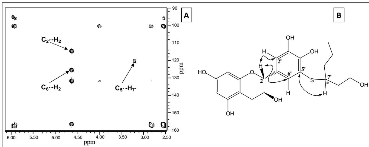
**Figure 42.** (A) Section de la carte HMBC de l'adduit 5'-(7'-sulfanylhexanol)-(+)-catéchine (C2), (B) structure de l'adduit C2 (les flèches représentent les principales corrélations proton-carbone à longue distance observées sur la carte HMBC)
