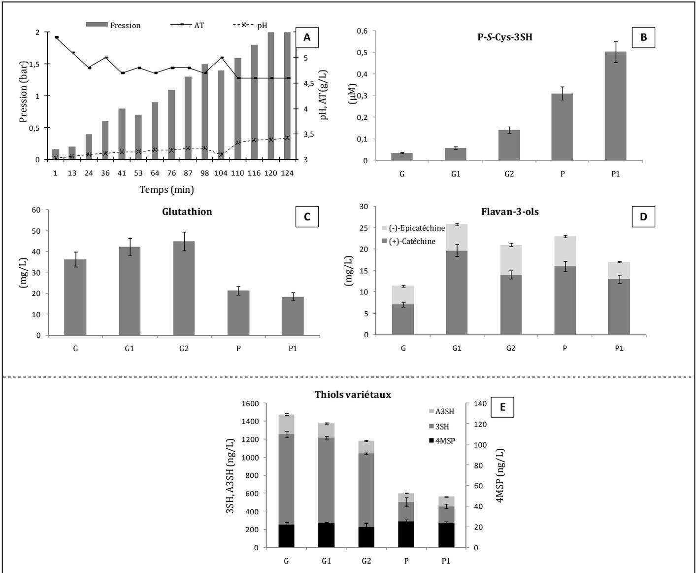
**Figure 72.** Evolution **(A)** du pH, de l'AT ainsi que des teneurs en **(B)** P-S-Cys-3SH, **(C)** glutathione, **(D)** flavan-3-ols des moûts au cours du pressurage des raisins. **(E)** Teneurs en 3SH, A3SH et 4MSP des vins issus des moûts obtenus à différents stades du pressurage
