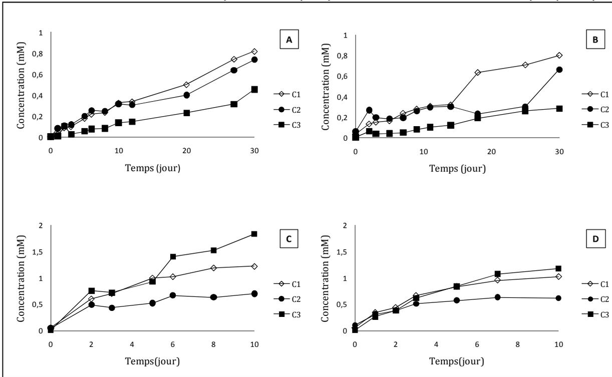
**Figure 53.** Cinétique de formation des adduits entre la (+)-catéchine et le 3SH (C1, C2 et C3) en conditions d'oxydation chimique. Incidence de la présence de fer ferreux et de dioxyde de soufre. (A) modalité contrôle, (B) en présence de dioxyde de soufre, (C) en présence de fer ferreux et (D) en présence de fer ferreux et de dioxyde de soufre
