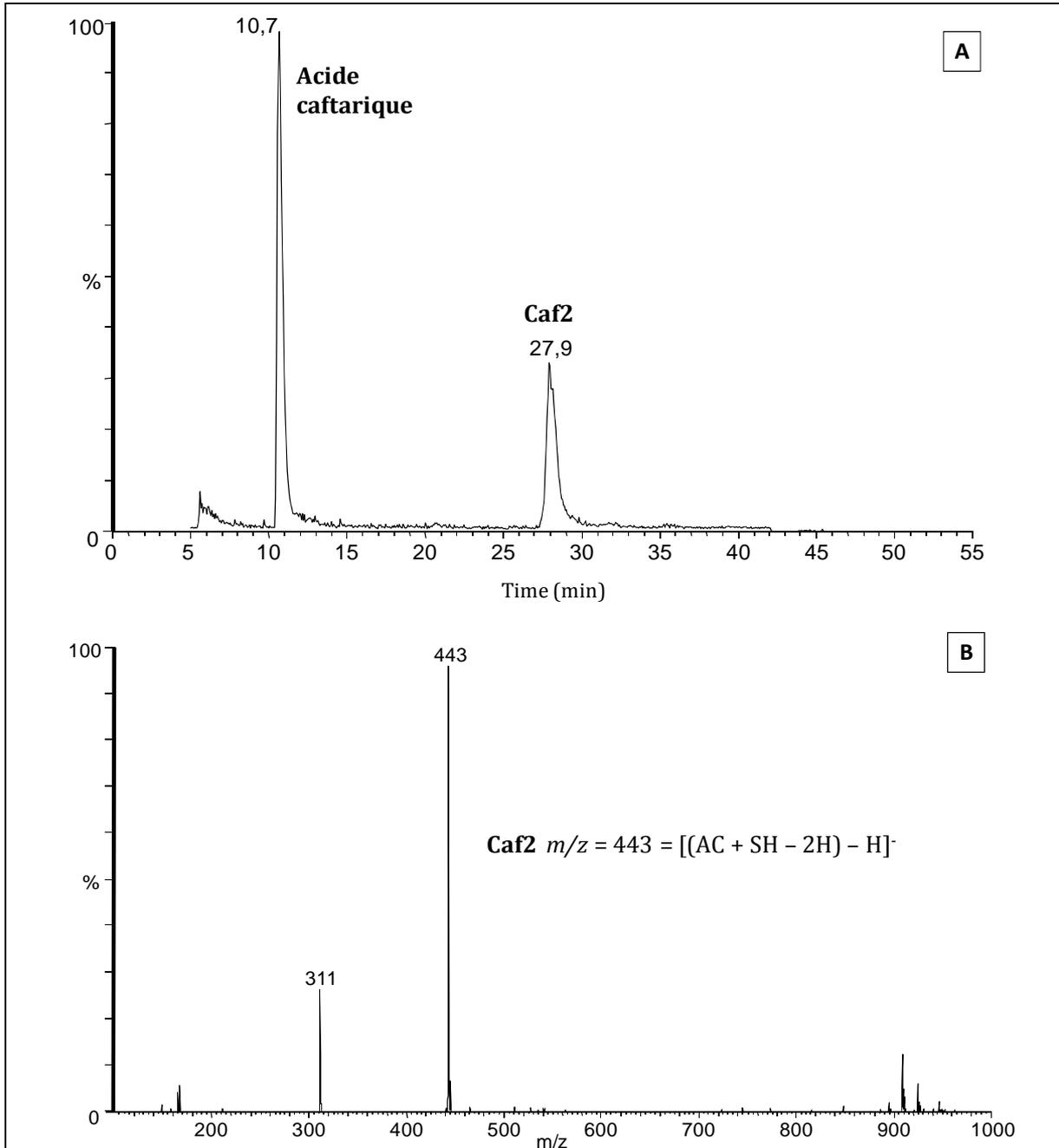
**Figure 48. (A)** Chromatogramme de masse du produit de synthèse après la réaction de l'acide caftarique avec le 3SH (Caf2) à six heures d'incubation. **(B)** Spectre de masse en mode négatif et en Full Scan sur la gamme des masses 100-1000 de l'adduit Caf2
