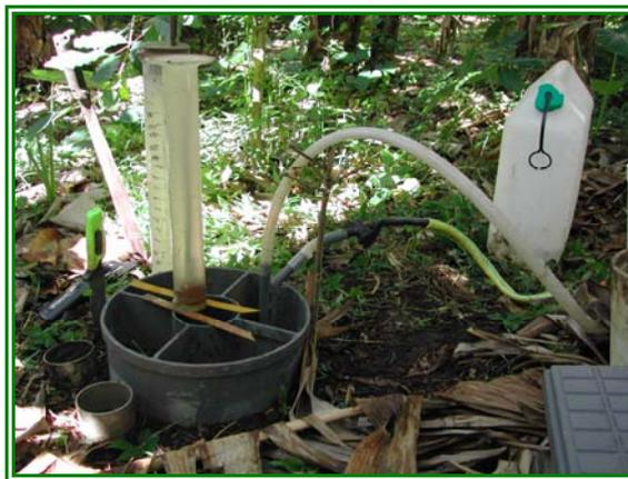
**Photo 2.2 : Infiltromètre à double-anneaux**
