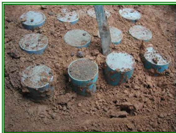
Photo 2.6 : Colonnes de sol prélevées au champ
