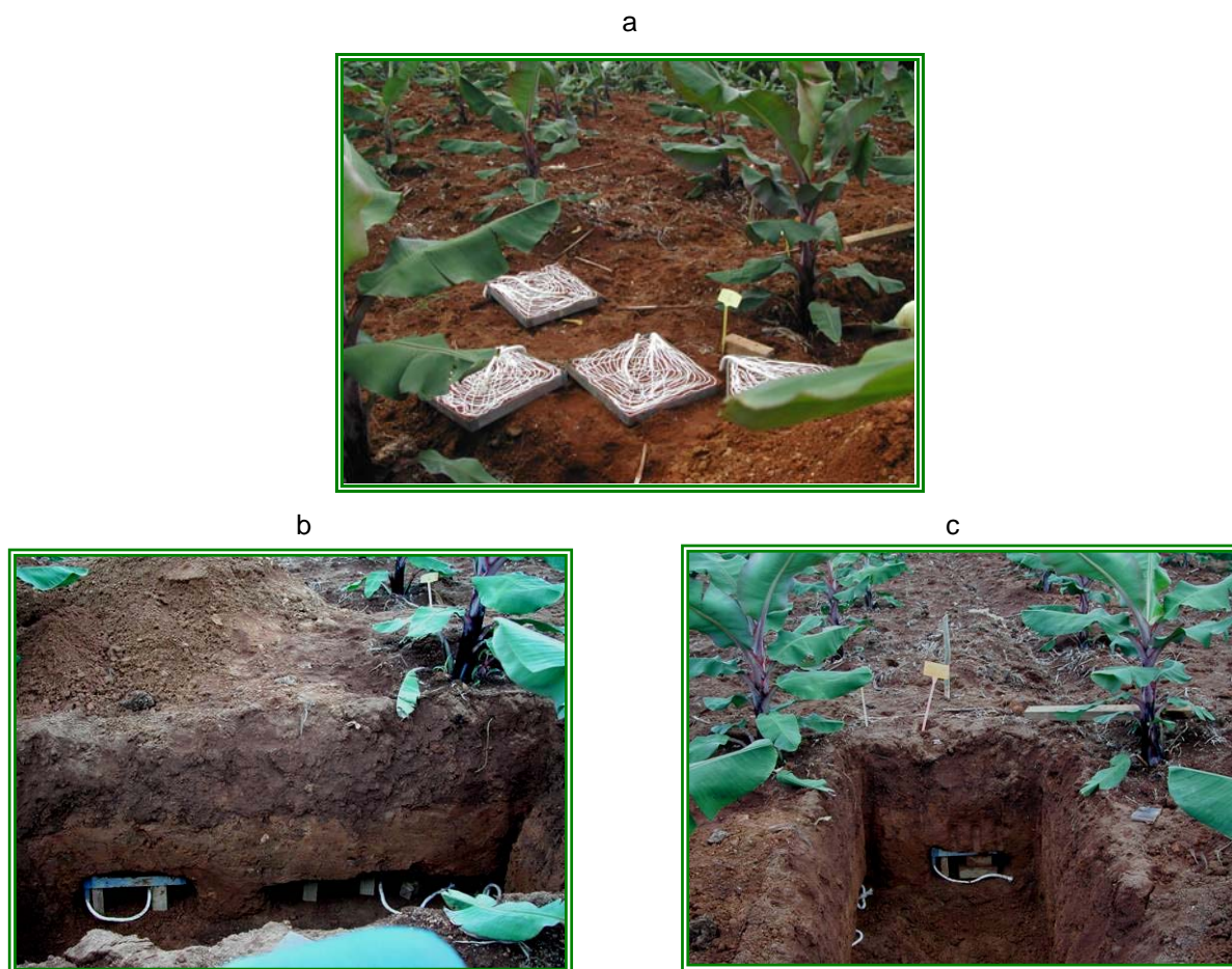
Photo 2.7 a-b-c : Lysimètres à mèches avant (a) et après installation dans le rang (lysimètre 1, 2 et 3, Photo b) et dans l'inter-rang (lysimètre 4, Photo c)
