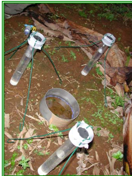
Photo 2.3 : Infiltromètre à charge nulle de type Beerkan (au centre) et infiltromètres à disques de type Decagon (sur les côtés)
