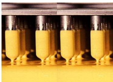
**Figure I.1-1.** Formation des gélules dures de gélatine par moulage par trempage.
