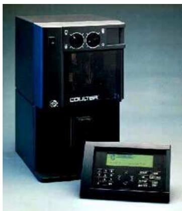
Figure 10 : Compteur à particules Coulter Counter Z2 (Beckman Coulter).
