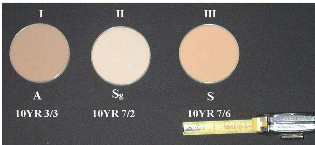
Photo 2. Matériaux originels après séchage et tamisage à 2 mm placés dans des boites de Petri.
