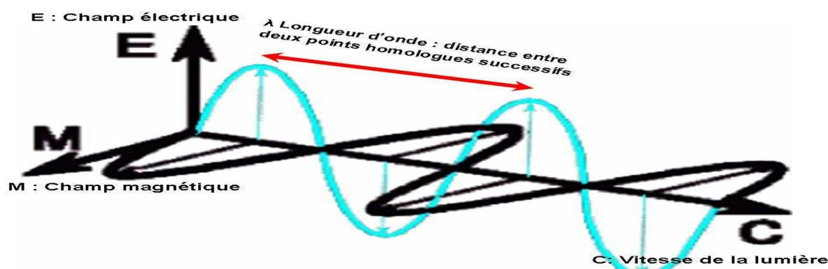
Figure 1. Représentation schématique des deux champs électrique (E) et magnétique (M) composant une onde électromagnétique (d'après Bonn et Rochon, 1992 dans Girard et Girard, 1999).
