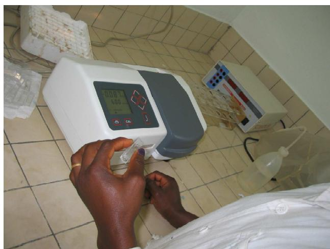
**FIGURE ANNEXE 2 : AJUSTEMENT AU SPECTROPHOTOMETRE DE L'INOCULUM PENDANT L'ESSAI DE PHENOTYPAGE DES RIL ET DES HD AU CAMEROUN.**
