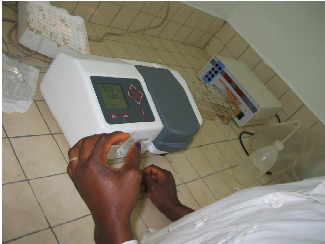
FIGURE ANNEXE 2 : AJUSTEMENT AU SPECTROPHOMETRE DE L'INOCULUM PENDANT L'ESSAI DE PHENOTYPAGE DES RIL ET DES HD AU CAMEROUN.
