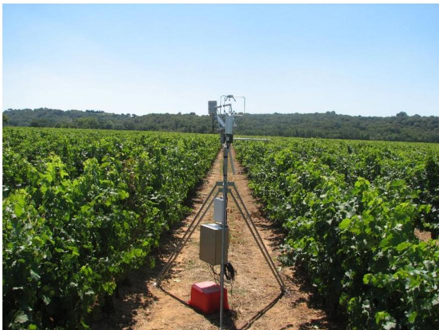
FIG. 2.11: Station de flux par covariances turbulentes sur le site 7
