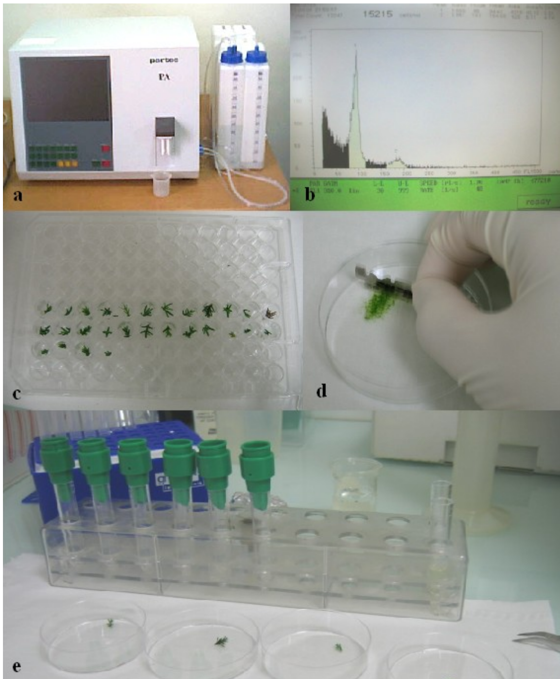
Figure 17. Estimation des niveaux de ploïdie des plantules de cyprès par cytométrie en flux. Cytomètre (a) et histogrammes observées sur son écran (b). Matériel végétal frais (c), hachage du tissu somatique afin de libérer les noyaux cellulaires dans le DAPI (d), et filtration de la solution obtenue avant d'être analysée dans le cytomètre (e).
