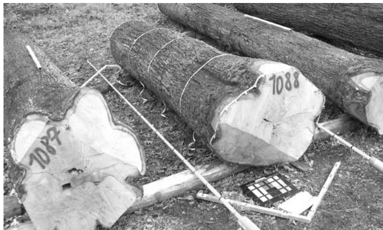
FIG. F32: Grume prête à être photographiée après disposition des règles, des équerres, des rubans et de la palette de couleurs de référence.
