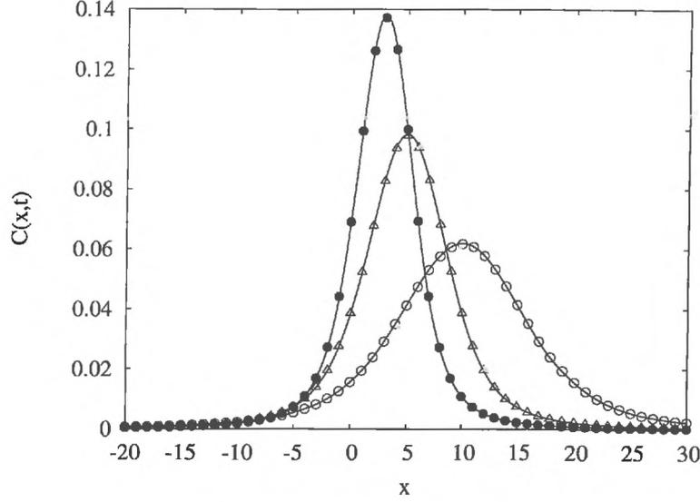
FIG. 6.4 – Comparaisons d’une simulation numérique avec la solution exacte dans un domaine infini, avec une vitesse non nulle, à partir d’une impulsion de Dirac en  $x = 0$ . La courbe supérieure correspond à  $t = 3$ , les suivantes correspondent aux  $t = 5$  et  $t = 10$ .
