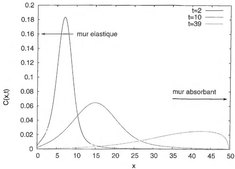
FIG. 6.12 – L'évolution de concentration en milieu borné par deux condition aux limites :  $\partial_x C(0, t) = 0$  et  $C(L, t) = 0$ . Calculée avec la méthode (5.10).
