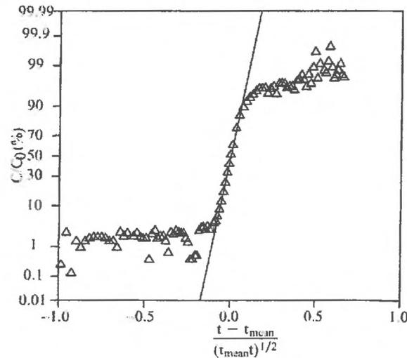
FIG. 2.4 – Graphique de la concentration normalisée par rapport au temps normalisé (Burns, 1997). La droite correspond au profil gaussien. Les triangles sont les données expérimentales.
