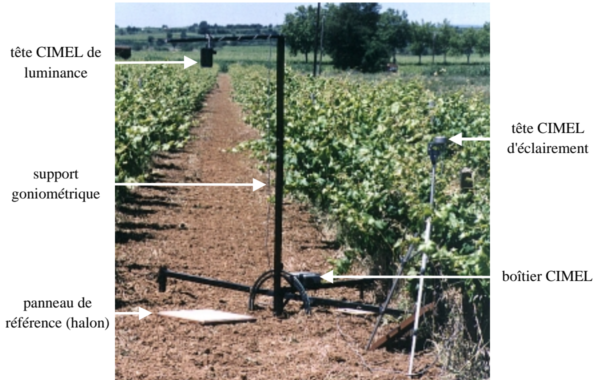
Figure 3.10 Le dispositif de mesures goniométriques. Le support, ici en position verticale, peut être incliné jusqu'à 60°. Les mesures sont effectuées dans le plan du soleil et perpendiculairement au plan du soleil.
