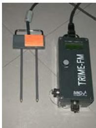
Les mesures TDR sont réalisées par des sondes P2G *in-situ* pour Fou30ans et Fou150ans.
