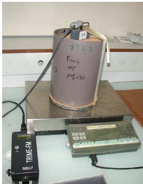
Mesure simultanée des humidités pondérale et volumique.
