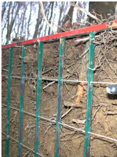
Observations en surface : l'enracinement apparaît au travers d'une grille de comptage racinaire.
