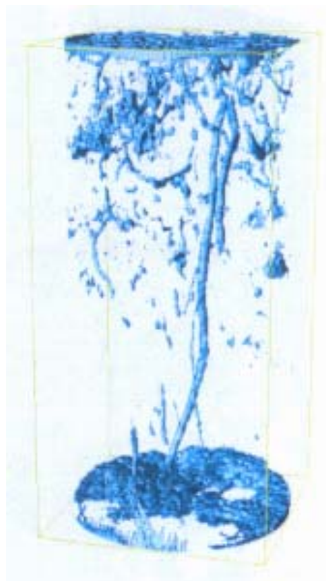
Figure I-6 : Image tridimensionnelle du sol par tomographie   rayon X. (d'apr s Delerue, 2001)
