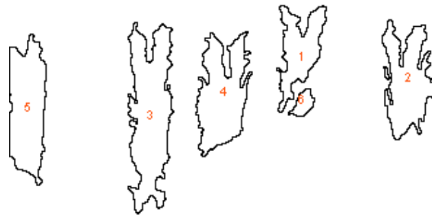
Figure 51 : Détection des contours des régions susceptibles d'être des nœuds.
