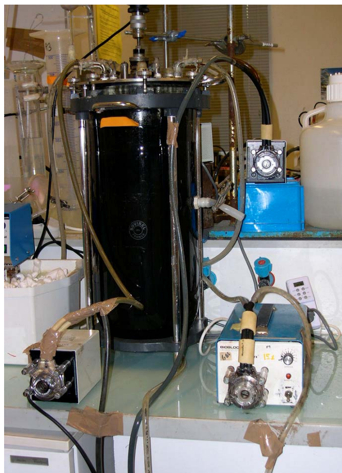
Figure D2. Réacteur de digestion anaérobie traditionnelle (R1).
