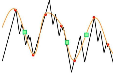
FIG. 3.1: Représentation d'un champ aléatoire (en noir) et de sa prédiction (en orange) passant par les points d'échantillonnage (cercles rouges). Les carrés verts correspondent aux points en lesquels nous voulons prédire la dérivée du champ.
