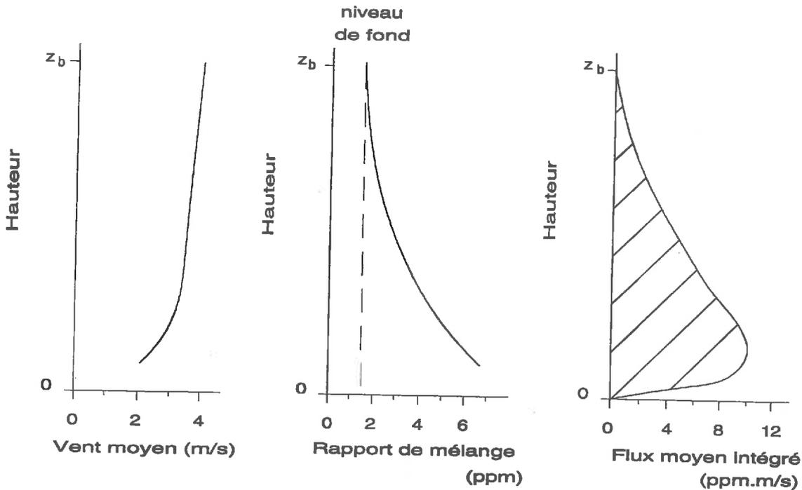
Figure 1.A.6 : schéma de principe de la méthode du bilan de masse
