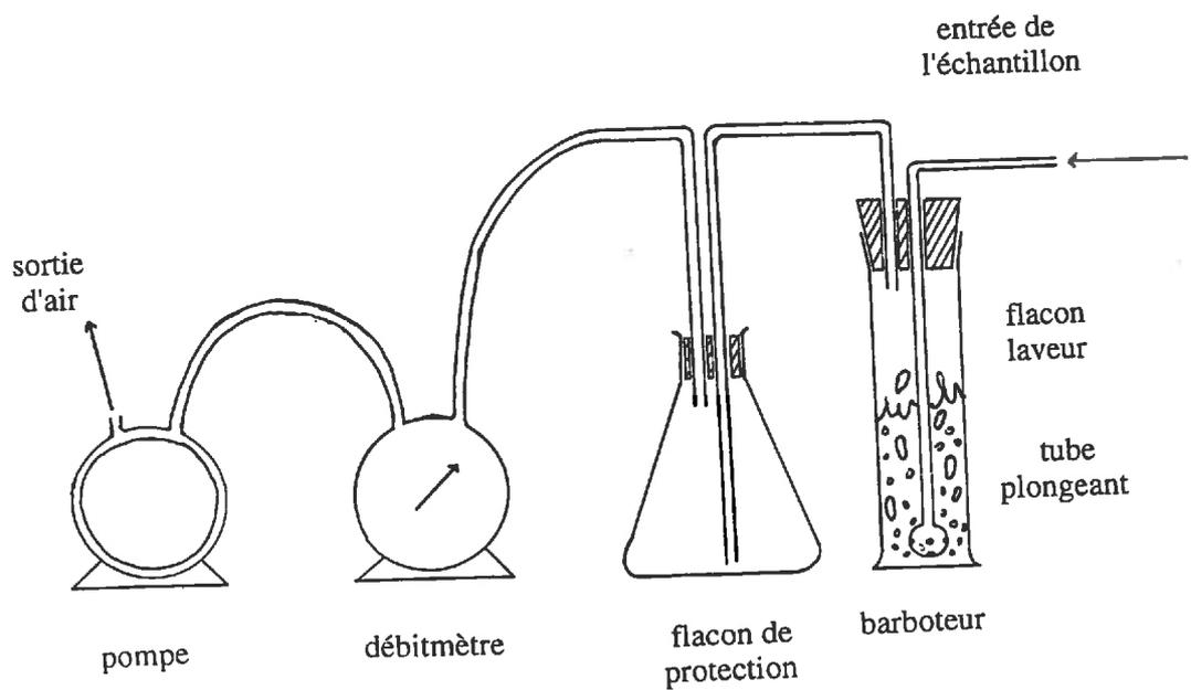
Figure III.B.5 : schéma d'un barboteur
