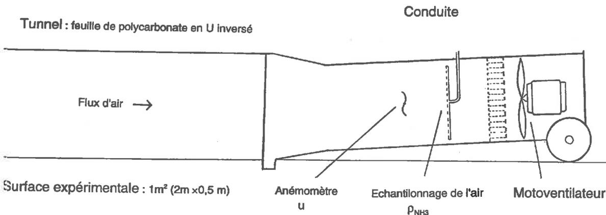
Figure 1.A.2 : schéma d'un tunnel de ventilation (d'après Lockyer, 1984)
