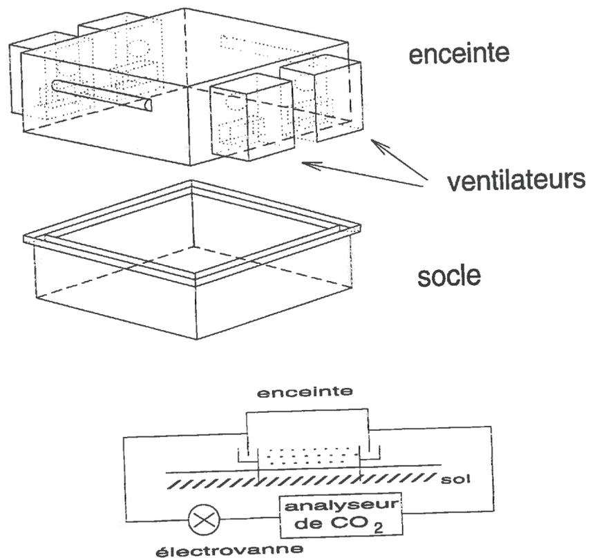
Figure III.D.1 : schéma de l'enceinte utilisée pour la mesure des flux de dioxyde de carbone (Chartier, comm. pers.)
