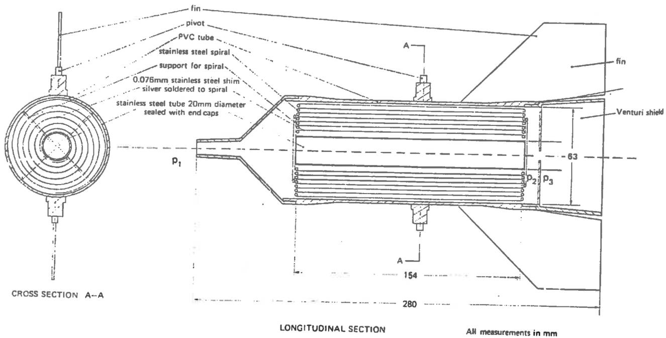
Figure 1.B.3 : schéma du capteur passif intégré d'ammoniac en forme de navette (Leuning *et al.*, 1985)
