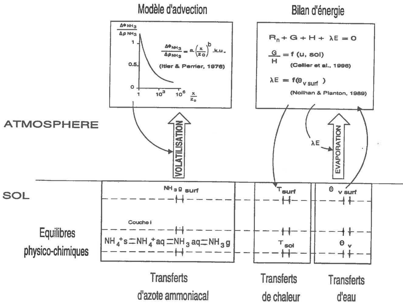
Figure II.B.5 : principales composantes du modèle de volatilisation d'ammoniac
