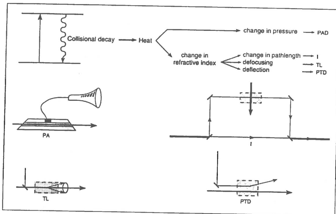
Figure 1.B.1 : quatre schémas différents utilisant l'augmentation de la température par absorption du rayon lumineux; le rayon laser excité est indiqué par une flèche traversant l'aire ombrée (de Vries, 1994)
