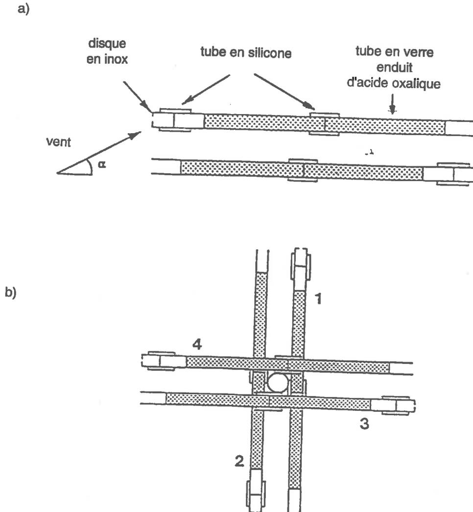
Figure 1.B.4 : capteur passif intégré de Schjoerring
