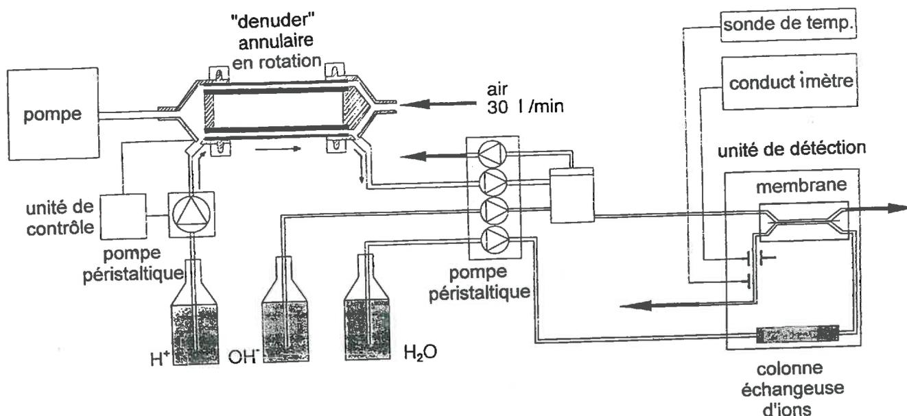
Figure 1.B.5 : schéma du capteur dynamique de type "wet-denuder" et analyse directe en continu par conductimétrie (d'après Wyers *et al.*, 1993 a et b)
