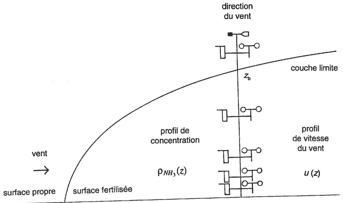
Figure III.B.4 : dispositif de la méthode du bilan de masse
