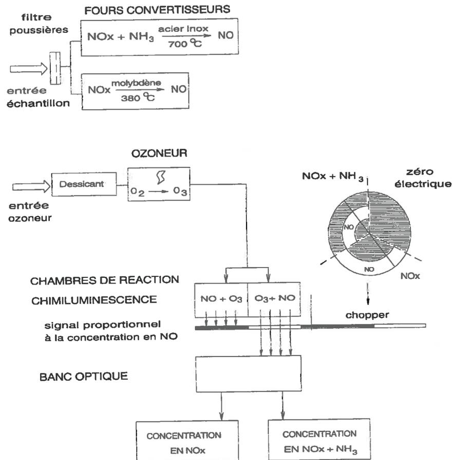
Figure III.B.2 : schéma de fonctionnement du NH30M (Environnement S.A., Poissy, France)
