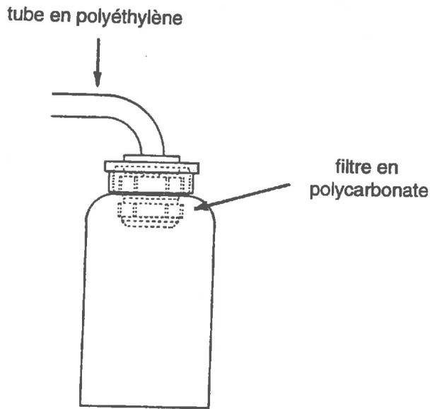
Figure 1.B.2 : schéma du capteur dynamique avec piégeage sur un filtre (Ferm *et al.*, 1988)
