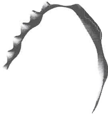
FIG. 4.4 – Très bonne triangulation d'une feuille (taille maximale du plus grand côté d'un triangle=0.02 cm)
