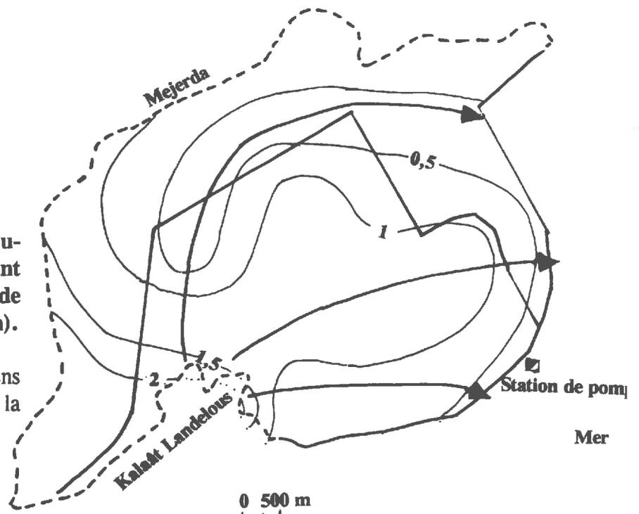
Figure 53. Gradient hydraulique général de la nappe avant assainissement. Profondeur de la nappe en janvier 1953 (en m).
