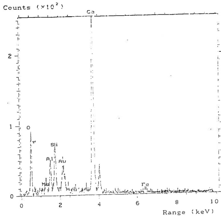
**Figure 36. Analyse au microsonde des cristaux de calcite-
