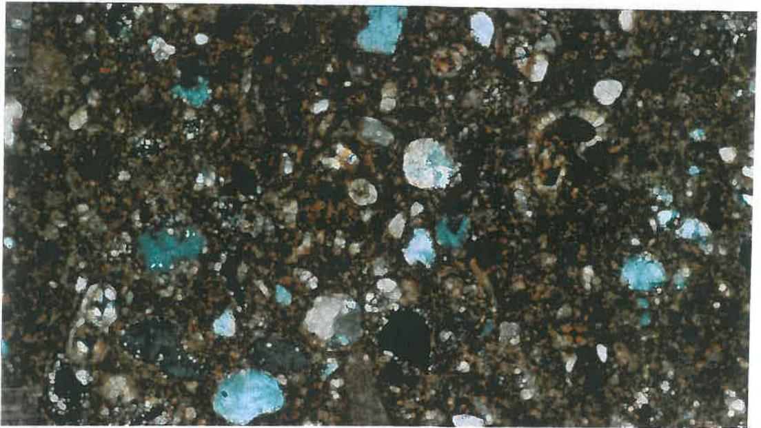
**Photo 3 (1 PL):** en profondeur (vers 1 m). Microstructure polyédrique angulaire. Masse basale hétérogène contenant des fragments d'argiles et de grains calcaires. Pédotraits: remplissages de vides par du matériau grossier.
