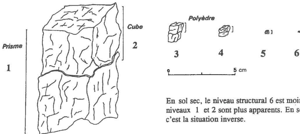
En sol sec, le niveau structural 6 est moins net. Les niveaux 1 et 2 sont plus apparents. En sol humide, c'est la situation inverse.
