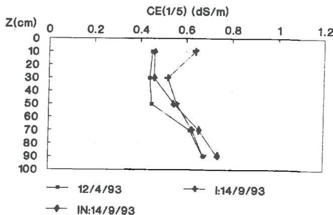
Figure 91. Evolution du profil salin au cours d'un cycle d'irrigation - été 92 et été 93.
