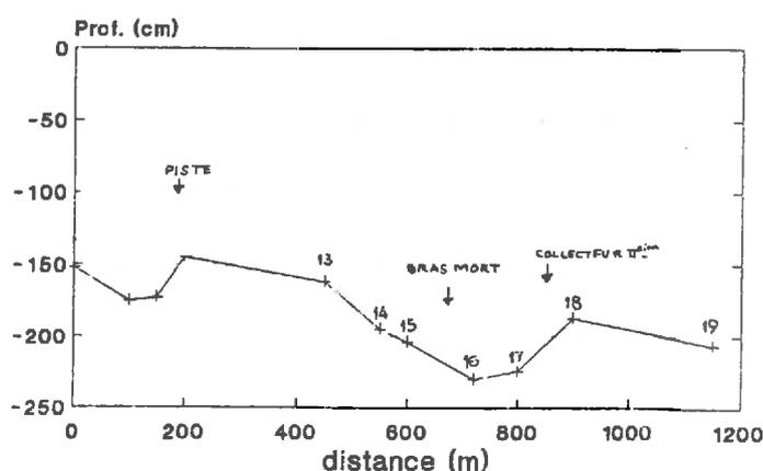
**Figure 79. Effet des pistes agricoles et des bras morts sur la profondeur de la nappe.**
