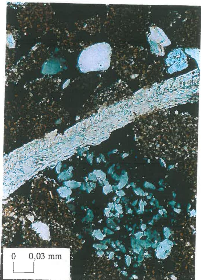
*Accumulation de gypse dans le vide inter-grains (pseudosables) en dessous d'un fragment de coquille (entre 4 et 4,5 m)*
