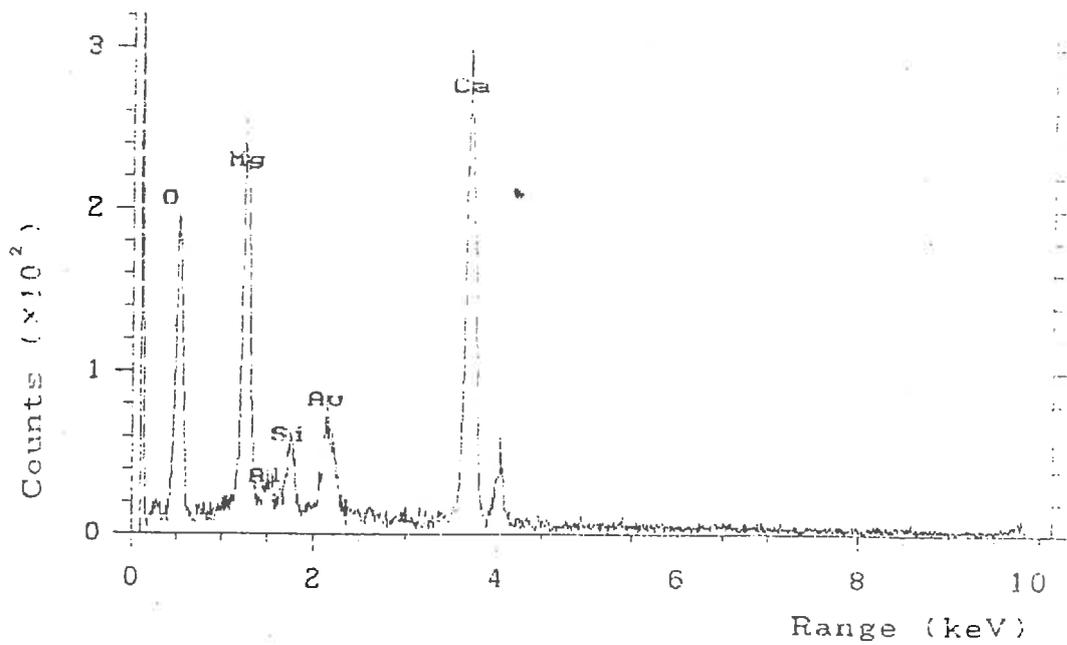
**Figure 34. Analyse au microsonde des cristaux de dolomite-
