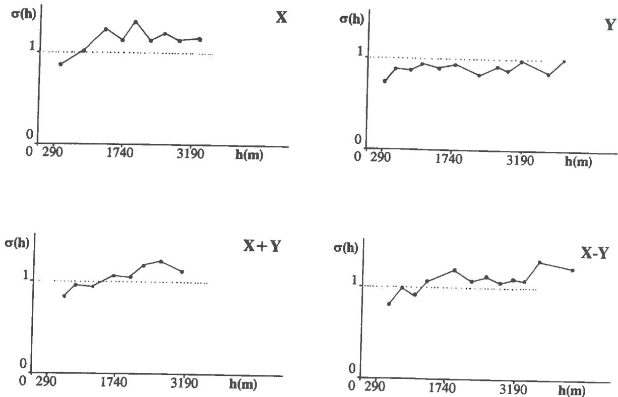
Figure 39. Variogrammes directionnels de la fraction argile+limon fin- Niveau 10 cm.
