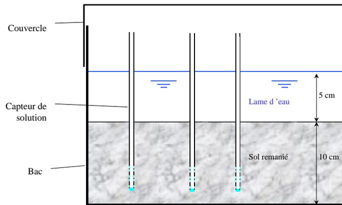
FIG. 5.1: Schéma du dispositif de suivi des caractéristiques chimiques à l'interface sol-lame d'eau
