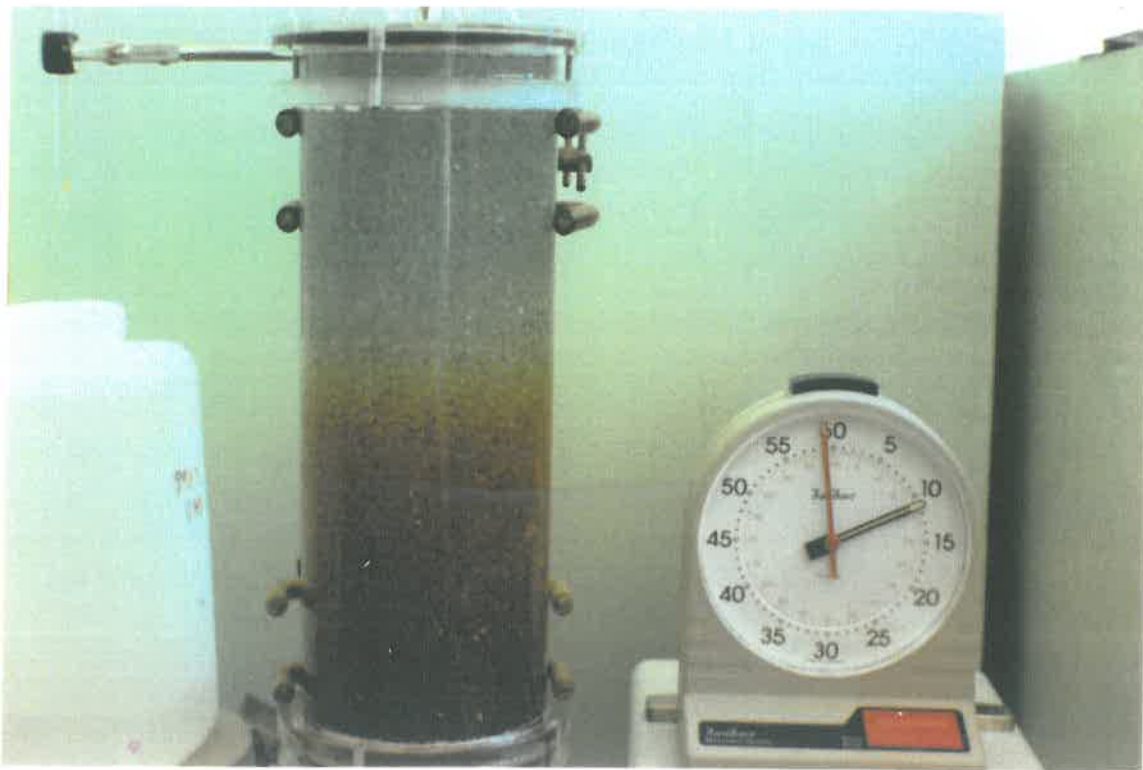
Photo 1 : Zone de mélange observée sur une colonne remplie de billes de verre en configuration d'écoulement stable. La solution la plus dense, de couleur ambre, déplace de façon ascendante la solution la moins dense, incolore.
