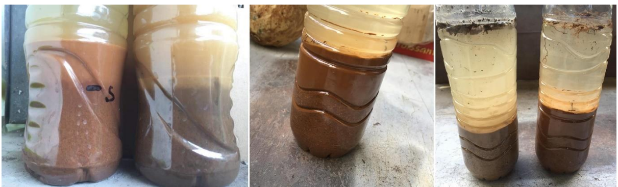
Figure 17 : Test de sédimentation
