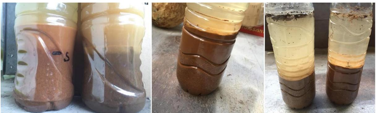
**Figure 17** : Test de sédimentation
