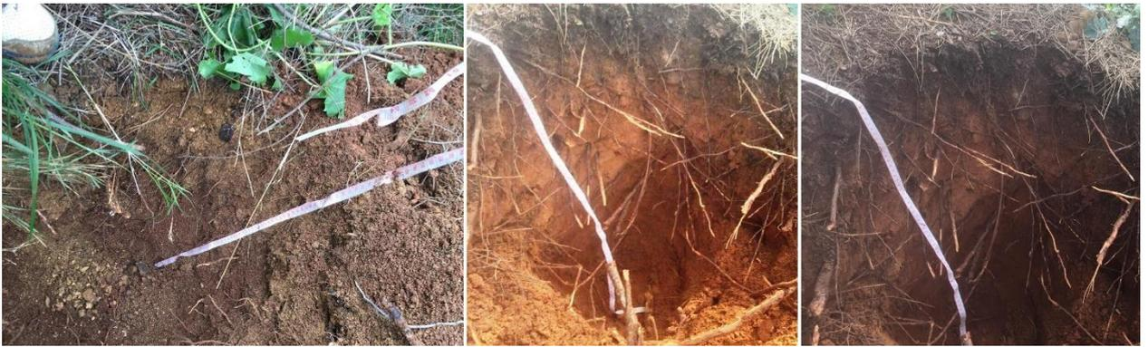
**Figures 16** : Mesures de l'épaisseur des horizons et l'épaisseur totale
