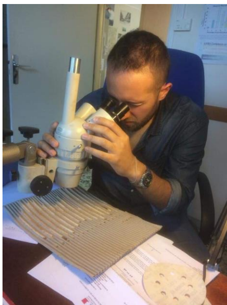
Figure 25 : Lecture des cernes à la loupe binoculaire avant l'analyse sur le logiciel WinDendro
