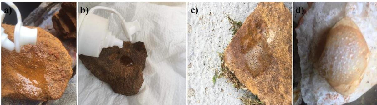
**Figure 14** : Test HCl avec a) et b) absence de réaction; c) et d) présence de réaction
