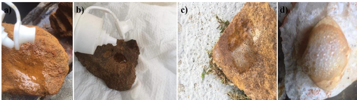
Figure 14 : Test HCl avec a) et b) absence de réaction; c) et d) présence de réaction
