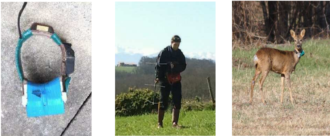
Figure 2 : Photos d'un collier GPS, d'une antenne « sika » et d'un chevreuil équipé d'un collier
