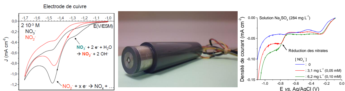
Figure 8. Détermination des potentiels de réduction des ions Nitrate et Nitrite, en présence de cuivre. Photo du prototype du capteur Nitradirect et détermination du potentiel optimal de réduction des ions nitrate
