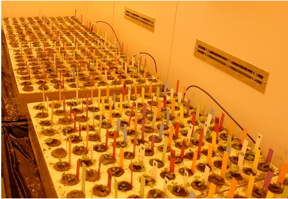
Figure III-1 : Photo illustrant le dispositif expérimental de l'évaluation de la tolérance au gel chez Medicago truncatula . Source Komlan Avia.
