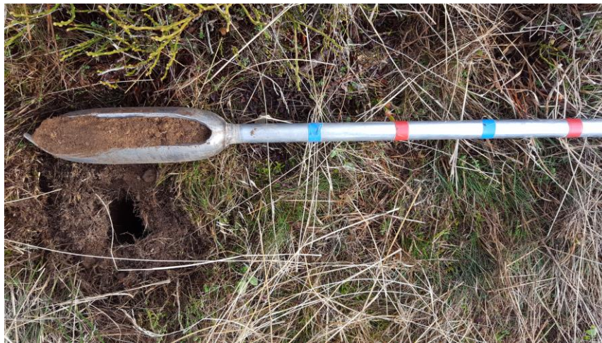
Figure 14 Echantillon de sol prélevé à la tarière
