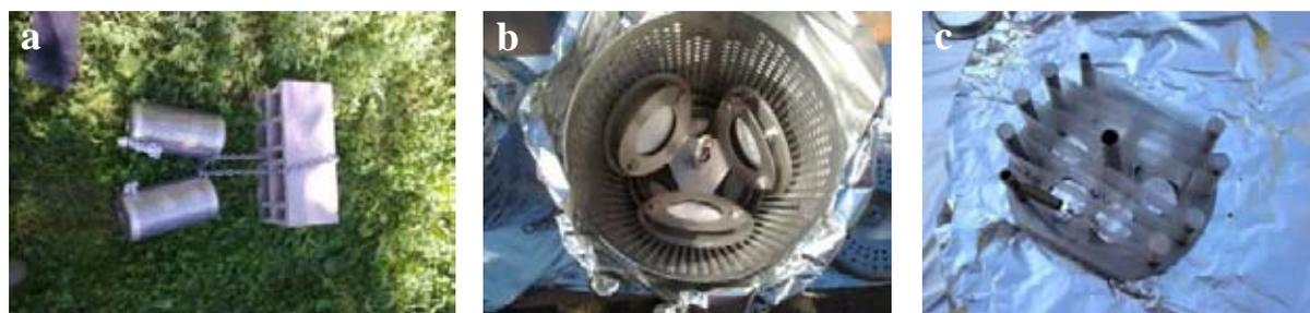
**Figure 29.** Photographies des POCIS et des SPMD avant leur déploiement
