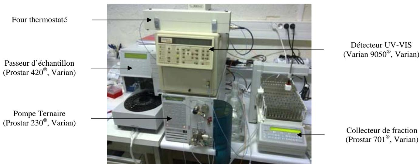
Figure 32. Système CLHP utilisé pour l'hyperfractionnement
