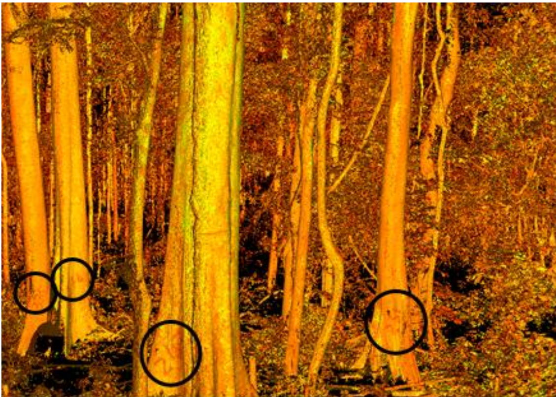
Fig. 22. Extrait d'un quadrat de 400 m 2 scanné au LiDAR terrestre et identification des arbres présent sur la base des numéros d'inventaire floristique (cercle noire).
