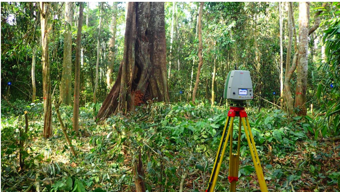
Fig. 10 : LiDAR terrestre C10 monté sur son trépied en forêt semi décidue du Sud-Est du Cameroun.
